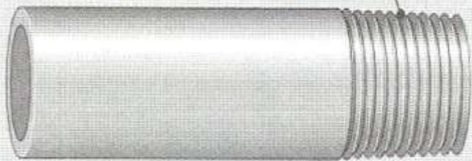
شکل ۹-۳۲ رزوه پایپ با استاندارد NPTF
