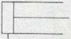
B. سیلندر یک کاره، با برگشت نامشخص
