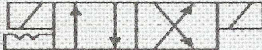
B. دو حالت ایستگاهی با دو سولنوئید
