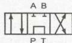
شیر چهارراهه، سه حالت، در حالت خنثی میانبر
