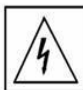
خطر برق گرفتگی
